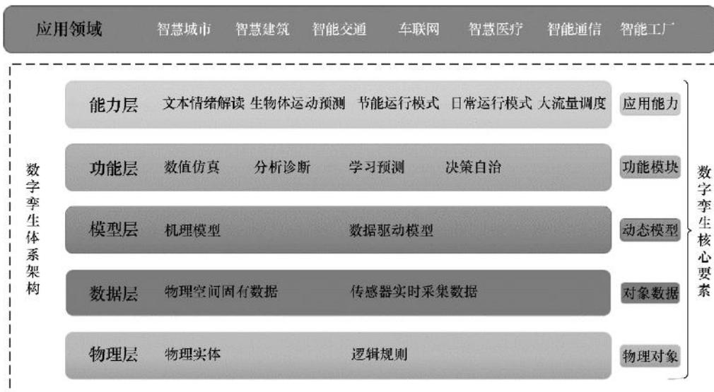
图 5.6.1.4-1 数字孪生体系架构图
